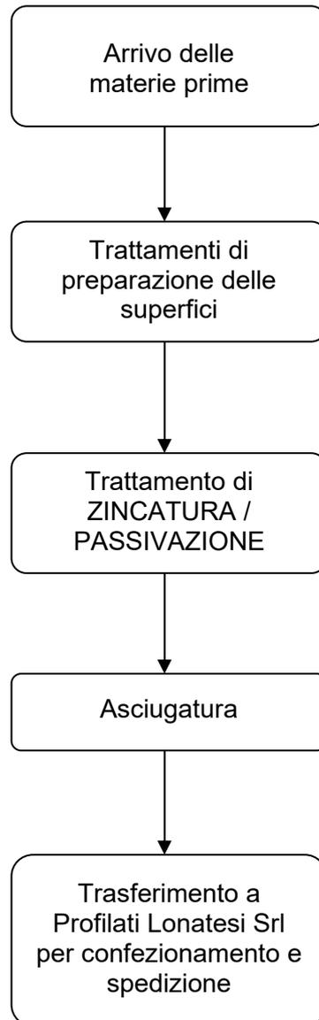
**Figura B1** – *Schema del processo produttivo*
